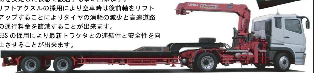
クレーン付きセフテーローダで最大積載量18tクラスを基準内で実現するセパレートパッケージです。農業、土木、建設等の機械を安心して搭載することが出来ます。
