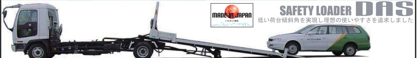
安全性を第一に考えた低スロープコンセプトのDAS中型クラスです。ダブルアクションスライド機構の搭載により低スロープを実現しました。スライド時、荷台後部の接地区間(引きずり)が短いため、消耗が少なく騒音が静かなうえ、路面にやさしいという特徴を兼ね備えております。
